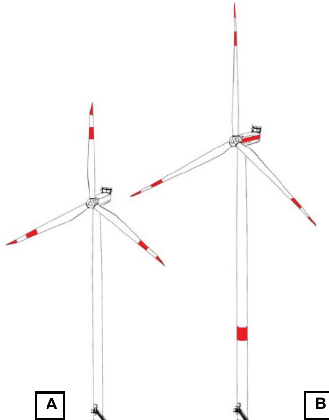
Abb. 1 Übersicht Kennzeichnungsmerkmale bei Anlagen 100 - 150 m (A) und >150 m (B) in Deutschland bei Tag
