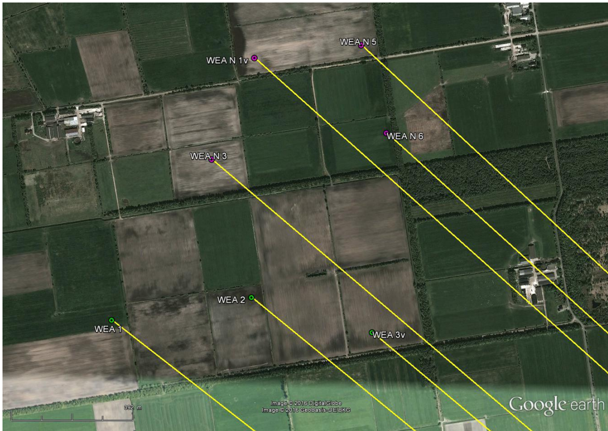
Abbildung 1: Gesamtübersicht des Windparks Dietrichsfeld der geplanten Windenergieanlagen (grün) sowie der benachbarten Windenergieanlagen Neuschoo-Südmoor. Die Einstrahlungsrichtungen bzgl. der Radaranlage Brockzetel sind gelb dargestellt.
