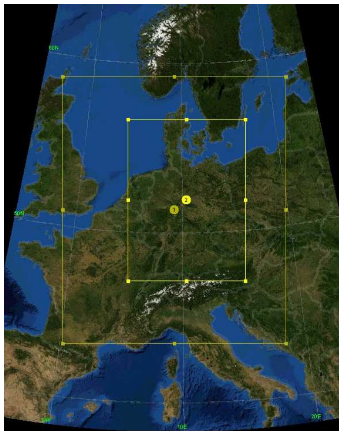
Abb. 2: Verschachtelte Domains der WRF Simulationen
