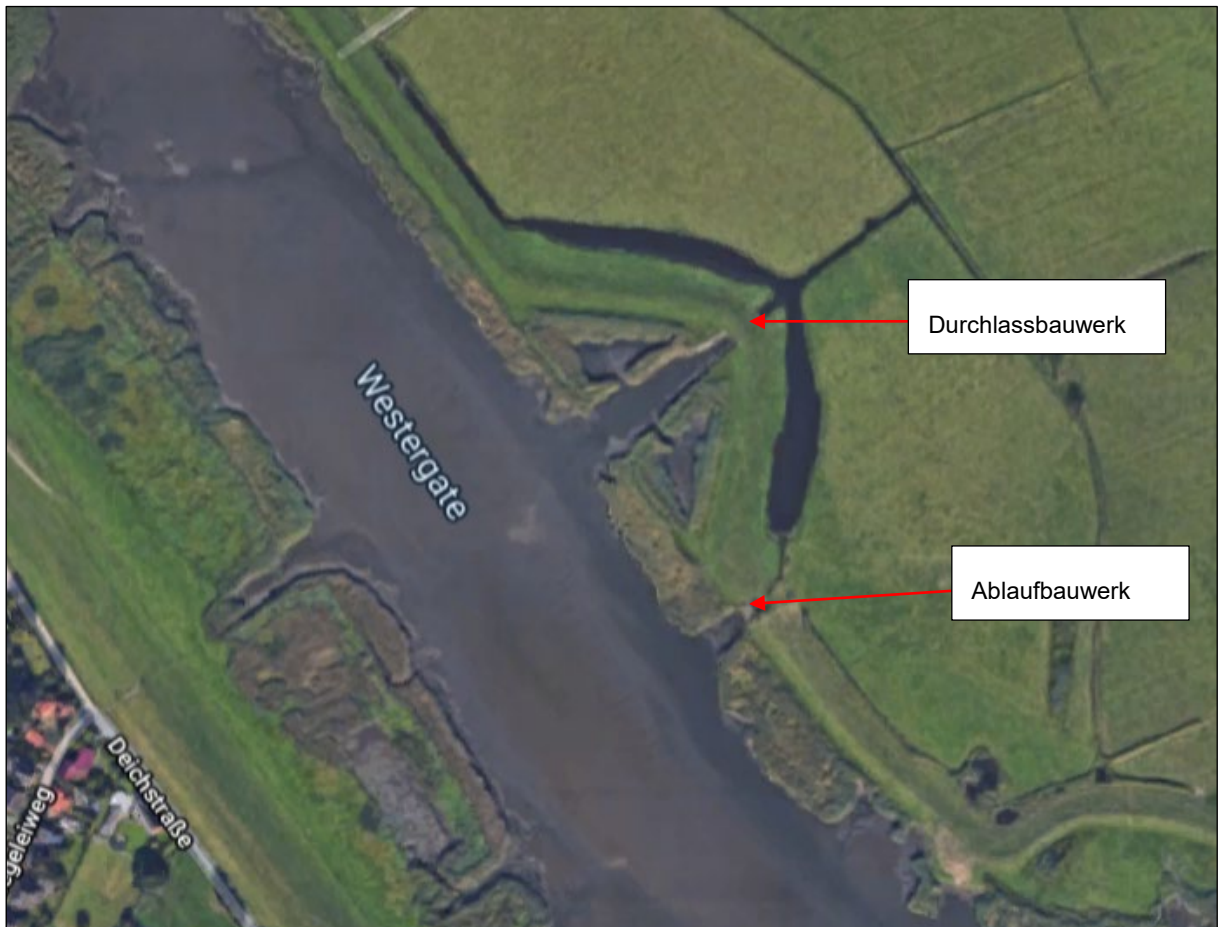
Abbildung 11: Lage Durchlass- und Ablaufbauwerk Weserseite
