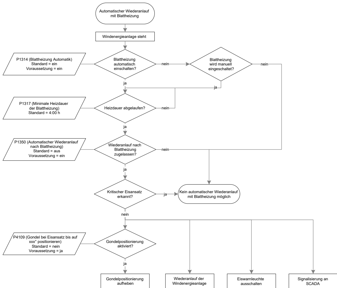
Abb. 3: Automatischer Wiederanlauf mit Blattheizung
