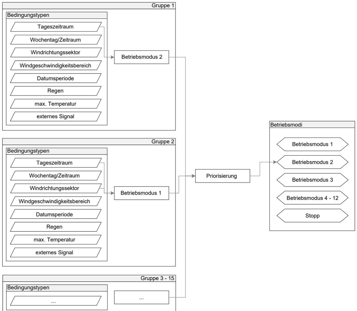
**Abb. 1: Funktionsweise der Schallreduzierung**
