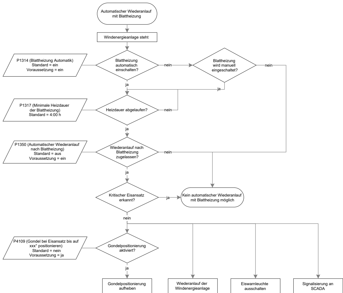
Abb. 3: Automatischer Wiederanlauf mit Blattheizung
