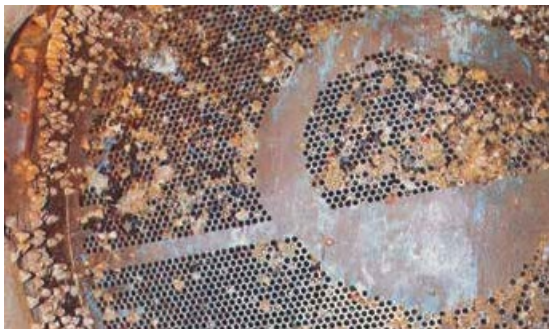
Abbildung 7: Beispiel für organischen Bewuchs bei einem mit Seewasser durchströmten Kondensator auf einem Schiff – links: entstandenes Biofouling welches die Sieblöcher sukzessive verstopft; rechts: das gleiche Sieb bei Einsatz von Natriumhypochlorit (Quelle: https://www.evoqua.com/siteassets/documents/products/electrochemical/gischloropacbr.pdf )
