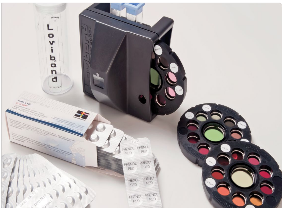
Abbildung 8: Kolorimetrisches System für die Wasseranalytik des Herstellers Lovibond; hier zur Bestimmung des Cl 2 -Wertes der FSRU-Abwasser-Teilströme
