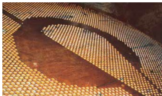
Abbildung 7: Beispiel für organischen Bewuchs bei einem mit Seewasser durchströmten Kondensator auf einem Schiff – links: entstandenes Biofouling welches die Sieblöcher sukzessive verstopft; rechts: das gleiche Sieb bei Einsatz von Natriumhypochlorit (Quelle: https://www.evoqua.com/siteassets/documents/products/electrochemical/gischloropacbr.pdf )
