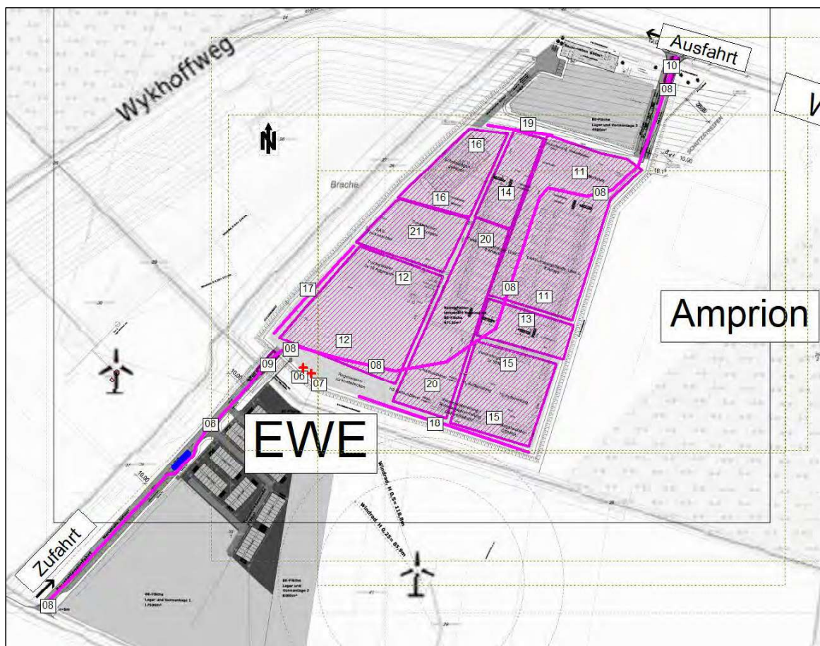
Abbildung 2: Auszug des 3D-Modells mit den Emissionsquellen/Baumaschinen im Bereich der Baufläche „Aufsandung“ (V1 und V2)
