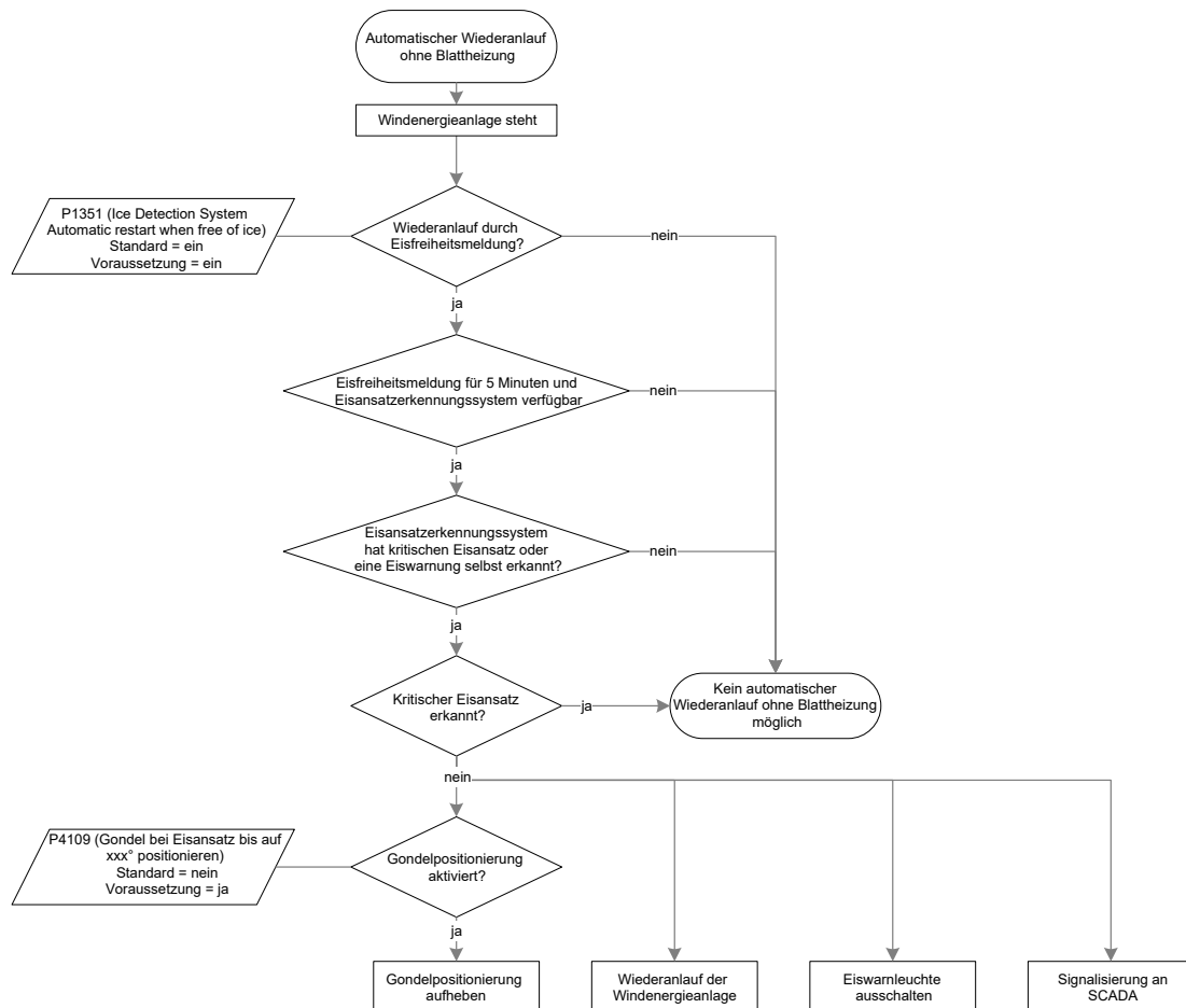
Abb. 8: Automatischer Wiederanlauf ohne Blattheizung
