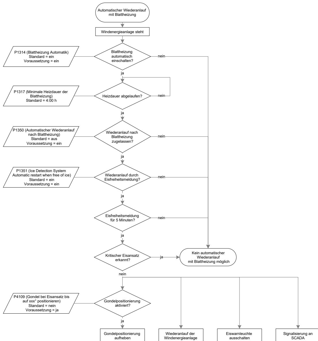
Abb. 7: Automatischer Wiederanlauf mit Blattheizung
