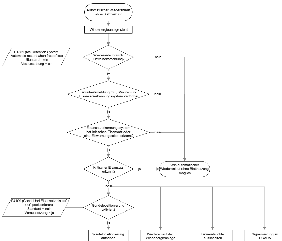
Abb. 8: Automatischer Wiederanlauf ohne Blattheizung
