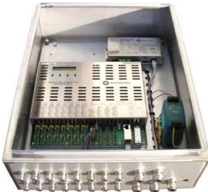
Abbildung 4: Diagnoseeinheit zur Datenerfassung (Diagnostic Data Acquisition Unit (DDAU))
