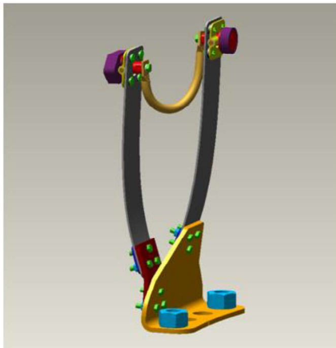
Abbildung 2-5: Blitzstrom-Übertragungseinheit zwischen Rotorblättern und Maschinenhausgehäuse
