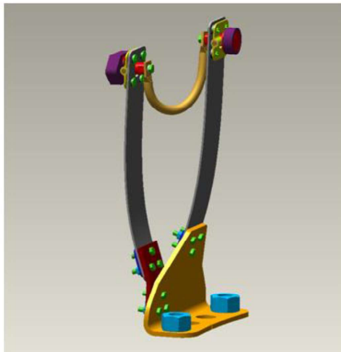
Abbildung 2-5: Blitzstrom-Übertragungseinheit zwischen Rotorblättern und Maschinenhausgehäuse
