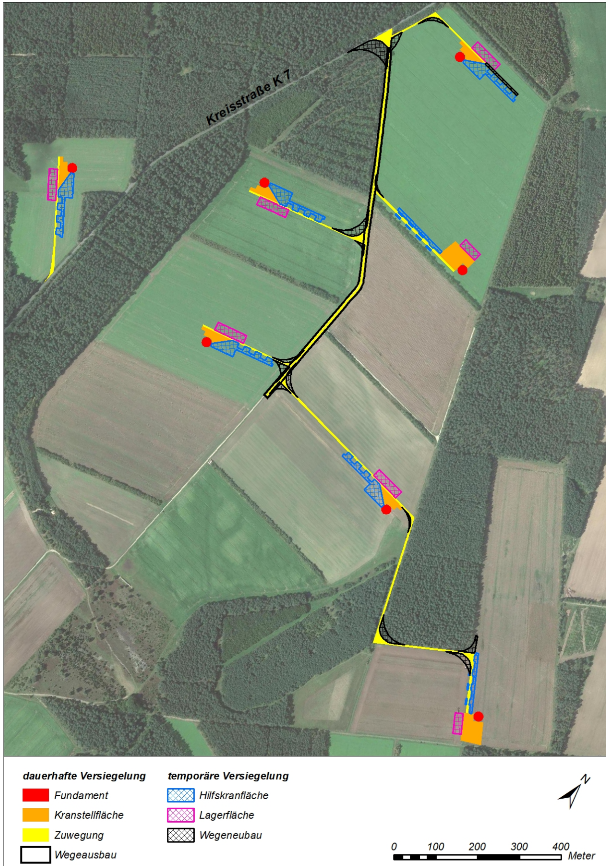
Abbildung 2: Umfang des Bauvorhabens durch Versiegelung
