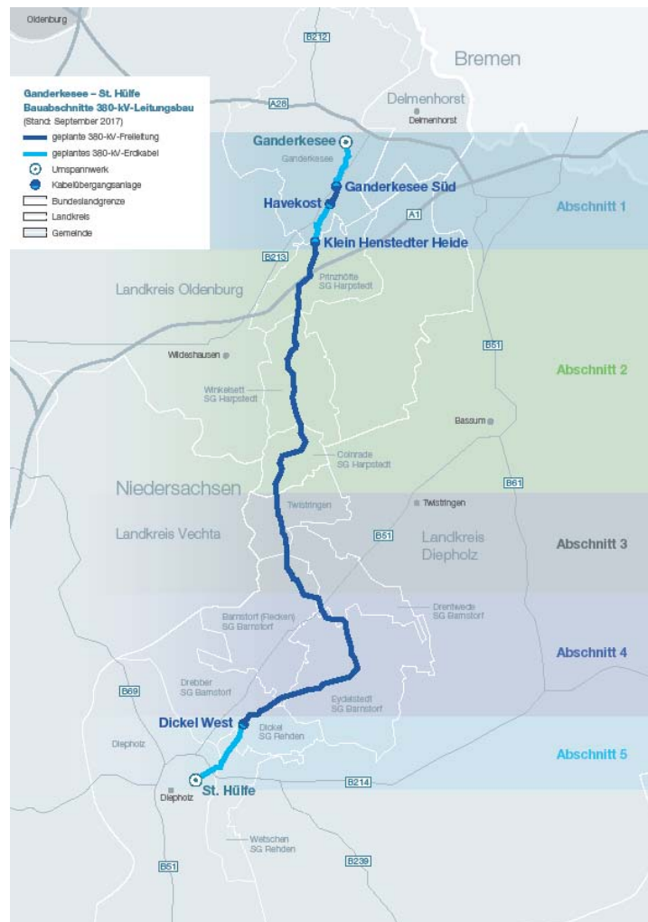
Abbildung 1: Trassenverlauf 380-kV-Leitung Ganderkesees – St. Hülfe
