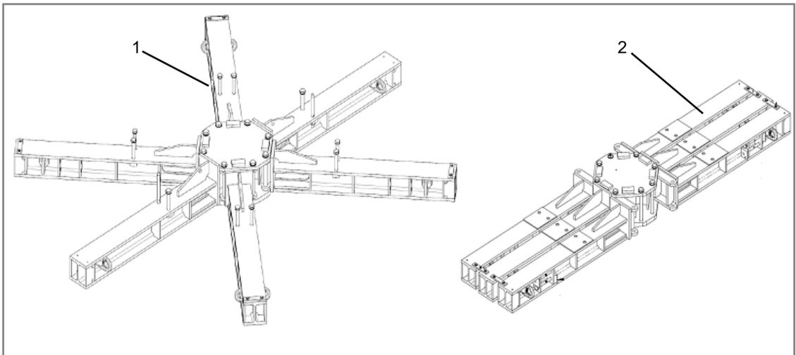
Abb. 9: Transportvorrichtung Nabe aufgebaut (1) und demontiert (2)
