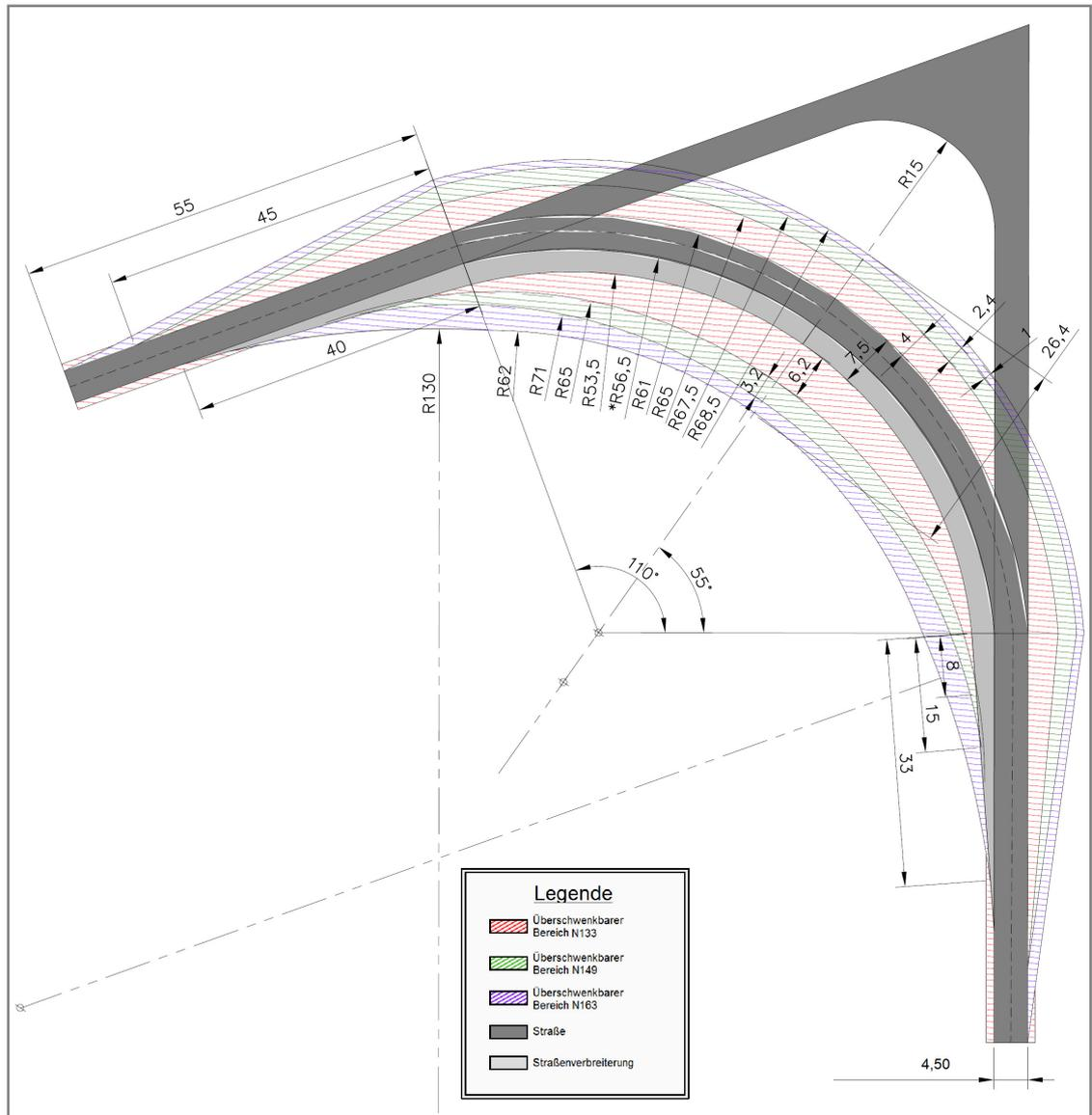
Abb. 13: Minimaler Ausbau 70°-Kurve allgemein, Darstellung ohne Einsatz einer zusätzlichen Schlepphilfe
