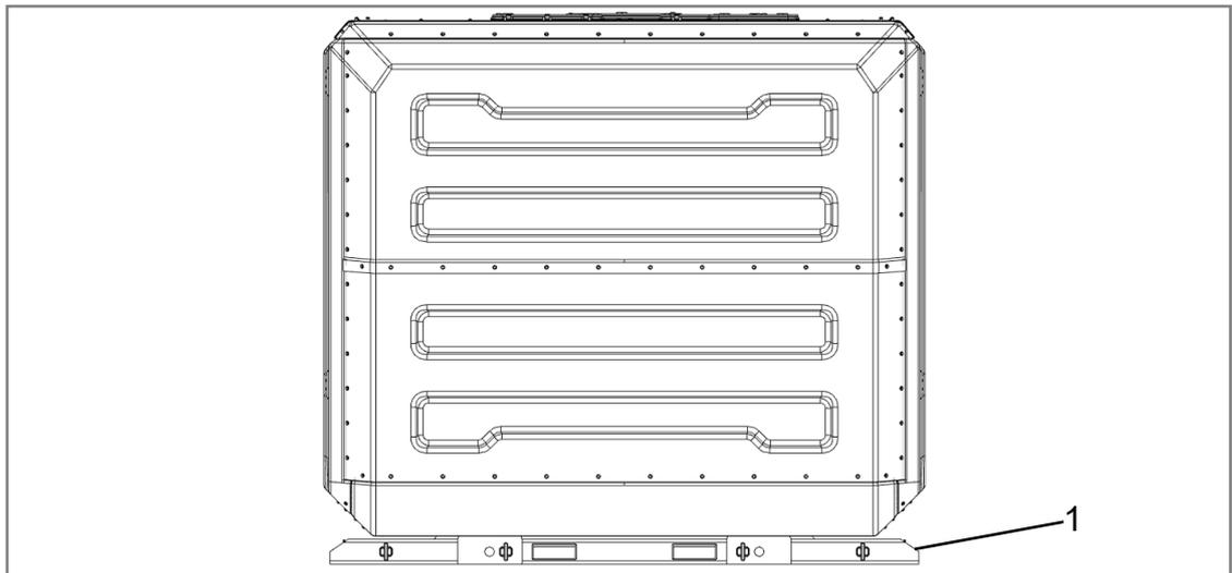
Abb. 2: *Beispieldarstellung Maschinenhaus, Ansicht von hinten mit Transportfüßen (1)*
