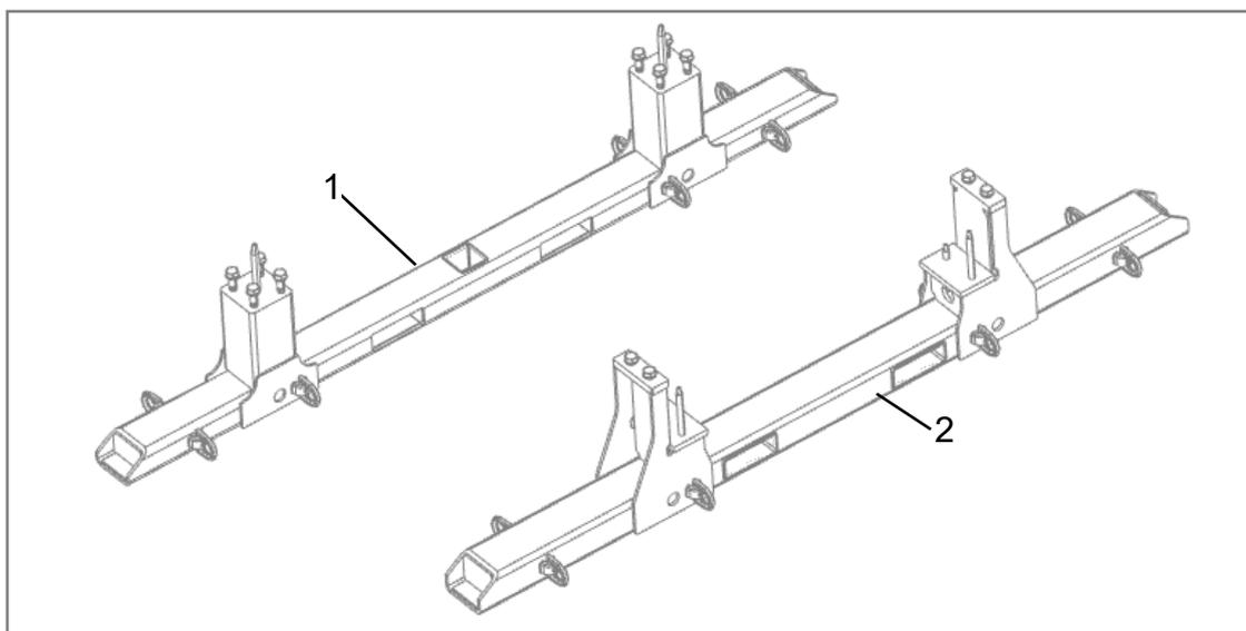
Abb. 7: Transportfüße Maschinenhaus vorn (1) und hinten (2), Abb. ähnlich
