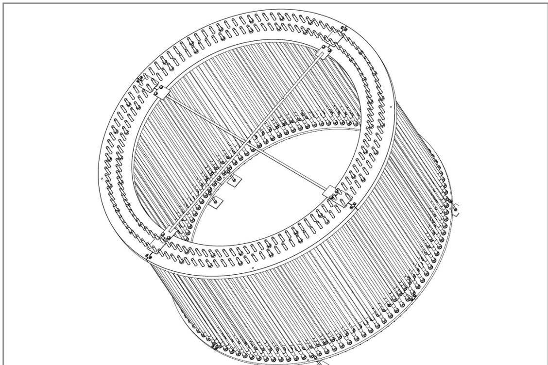
Abb. 10: Beispiel für einen Ankerkorb mit 4 x 56 Ankerbolzen
