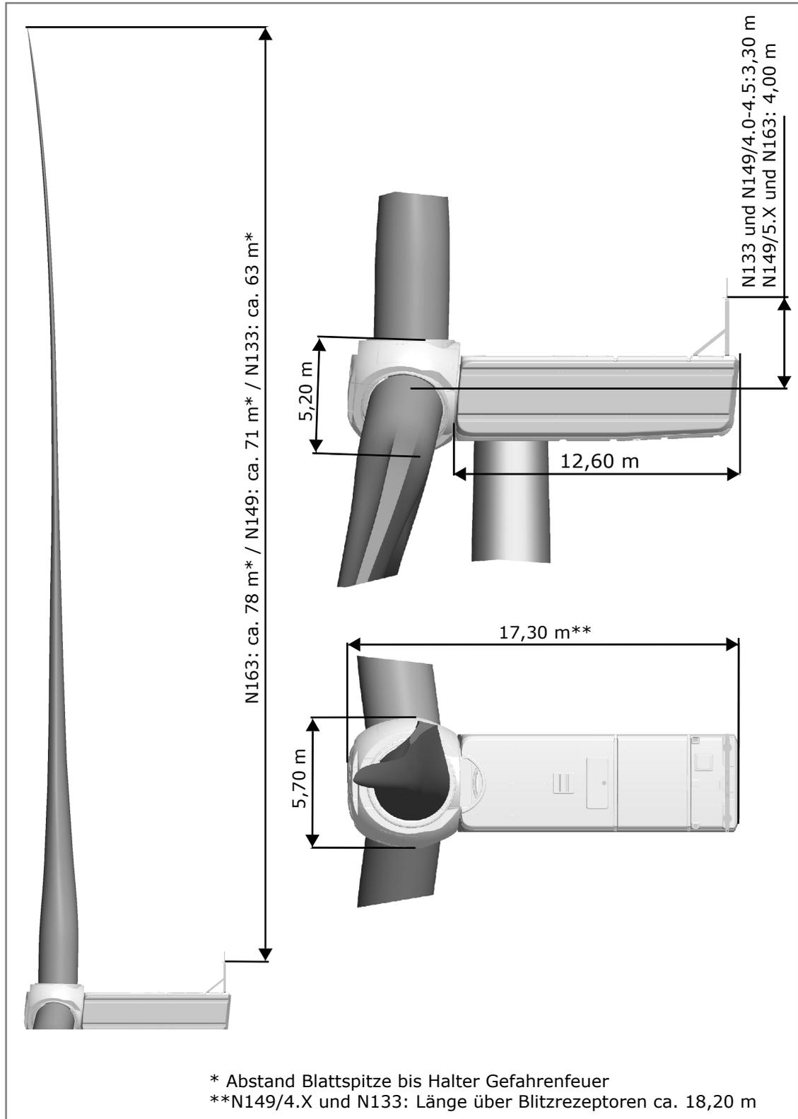
Abb. 1: Abmessungen Maschinenhaus
