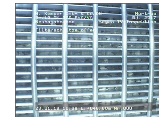
2_15A Filterschütze (aufgenommen bei 46,6 m)
