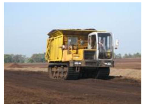
Abbildung 1: Selbstfahrender Kettendumper beim Torftransport (Foto AWT)
