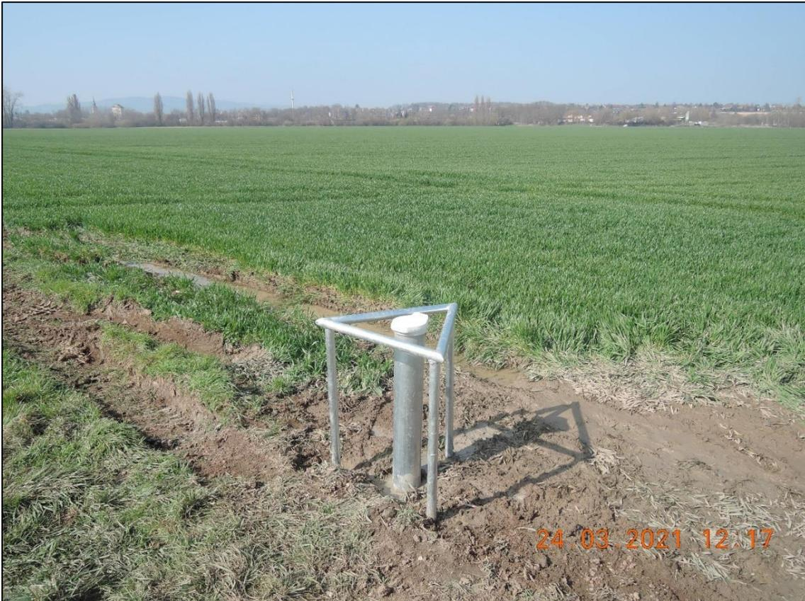
**Abb. 4: Grundwassermessstelle 03/21 mit SEBA-Kappe und Schutzdreieck.**
