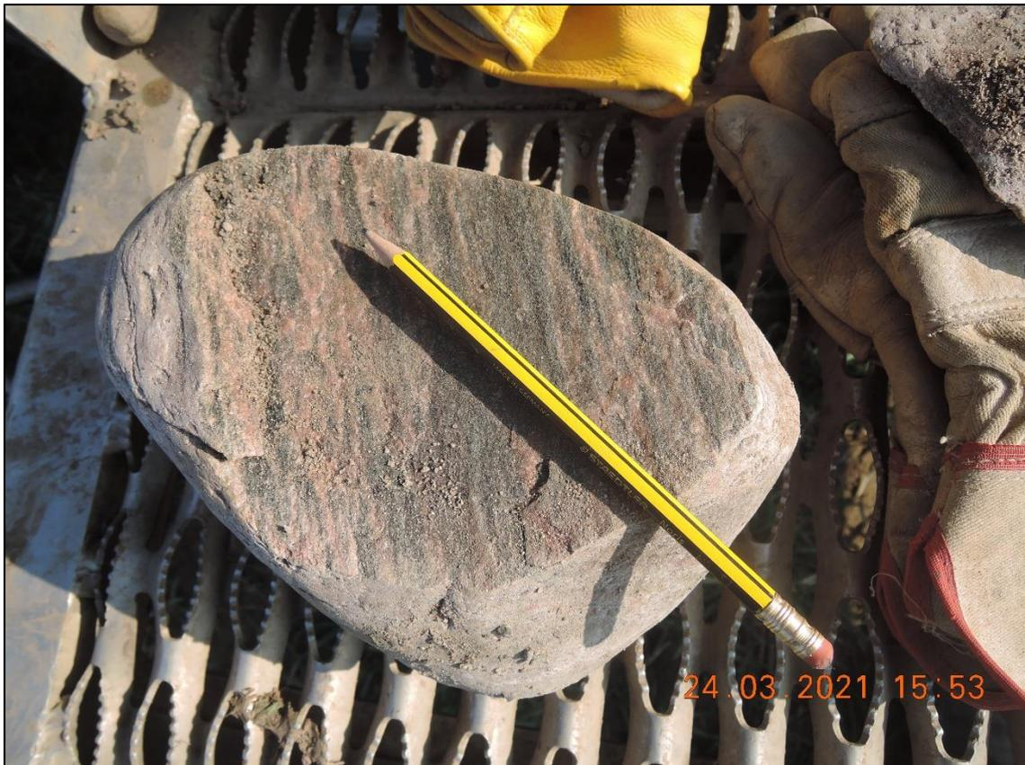
**Abb. 5: Gneis-Geröll von der Basis der Kiessandabfolge in GWM01/21.**
