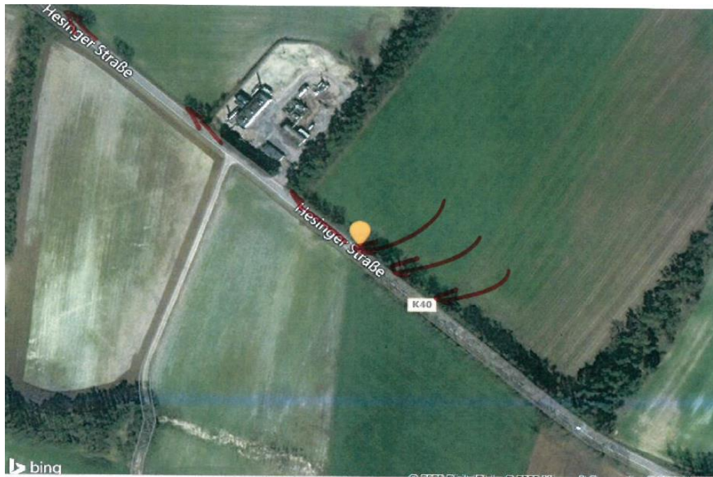
Abbildung 50: Problem: „Oberflächenwasser läuft vom Acker über die Fahrbahn (ca. 150 m) in tieferliegende Fläche“ [Landkreis Grafschaft Bentheim]
