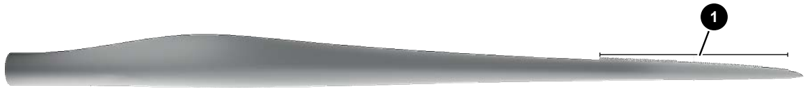
Abb. 1: Position der Hinterkantenkammsegmente am Rotorblatt
