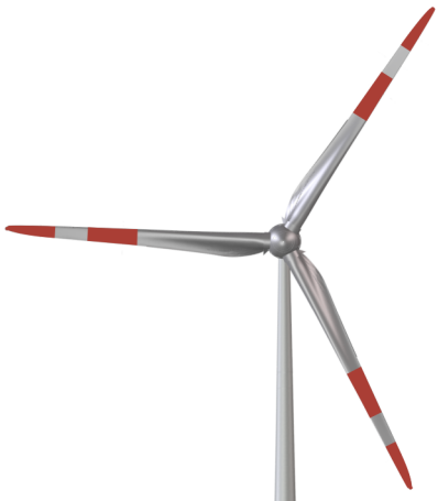
Abb. 3: Farbliche Kennzeichnung am Rotorblatt, beispielhafte Darstellung
