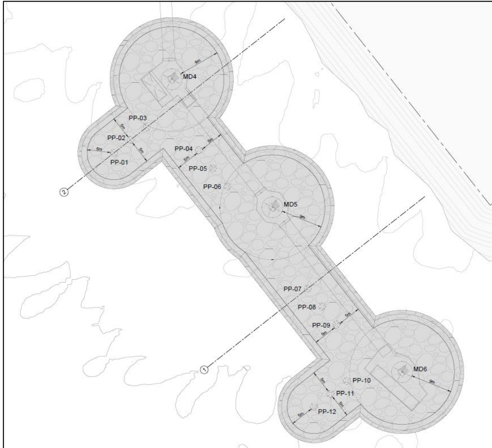
Abbildung 4-3 Konfiguration des Kolksschutzes um die Ponton-Pfähle.
