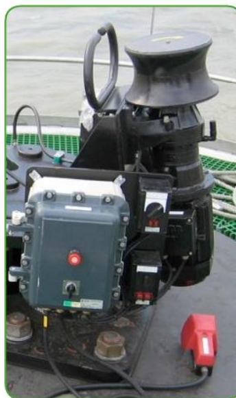
Abbildung 6-3 QRH mit integrierter Verholwinde
