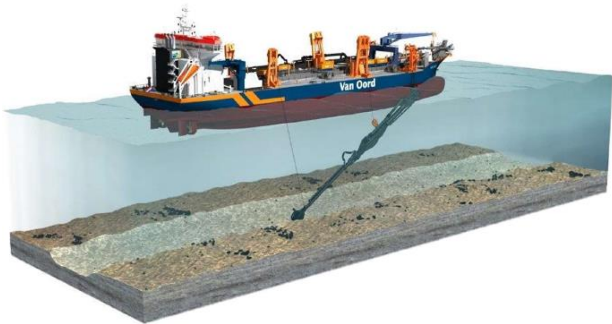
Abbildung 25 - Laderaumsaugbagger für die Ausbaggerung der Zufahrt und Liegewanne
