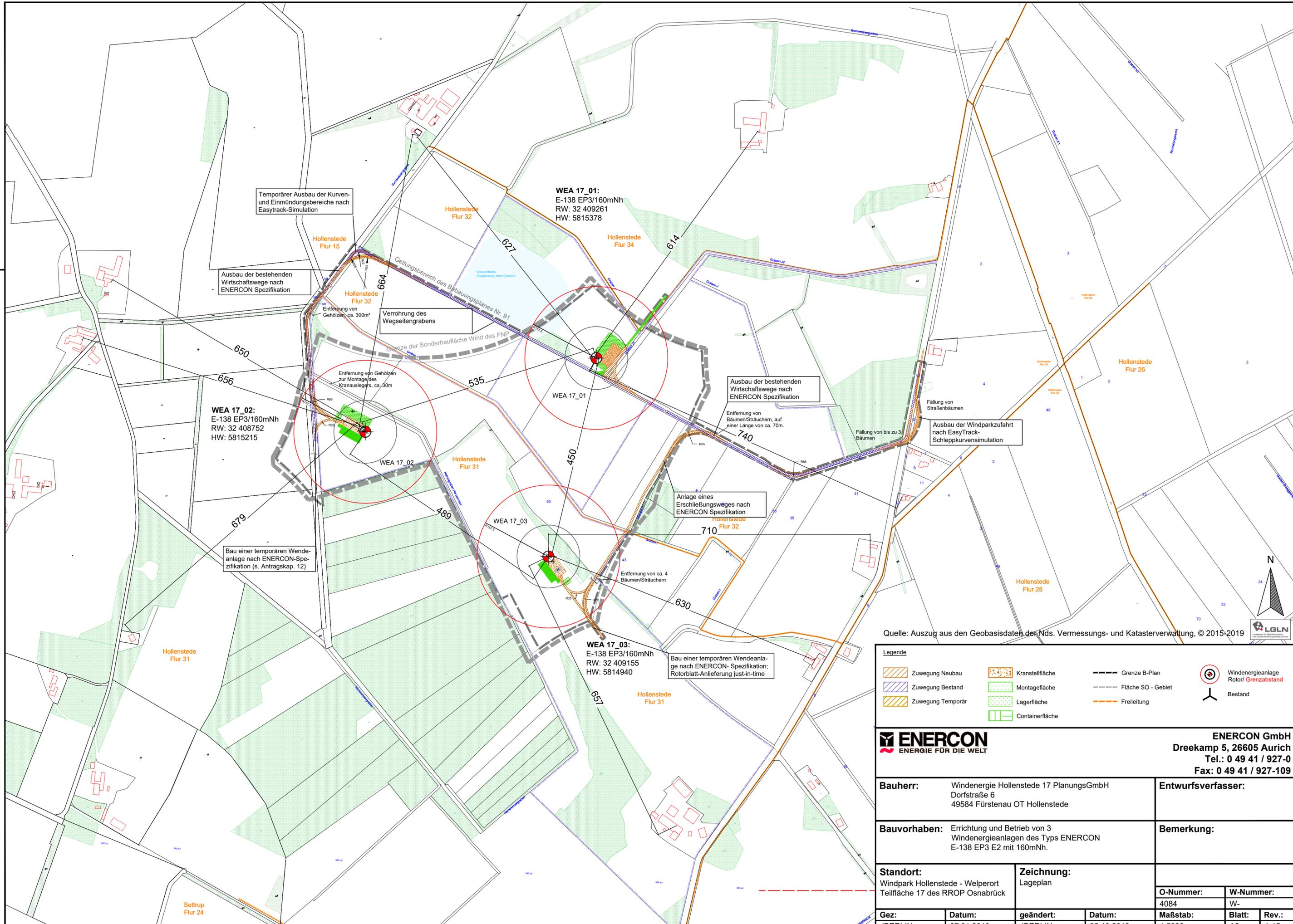
Temporärer Ausbau der Kurven- und Einmündungsbereiche nach EasyTrack-Simulation
