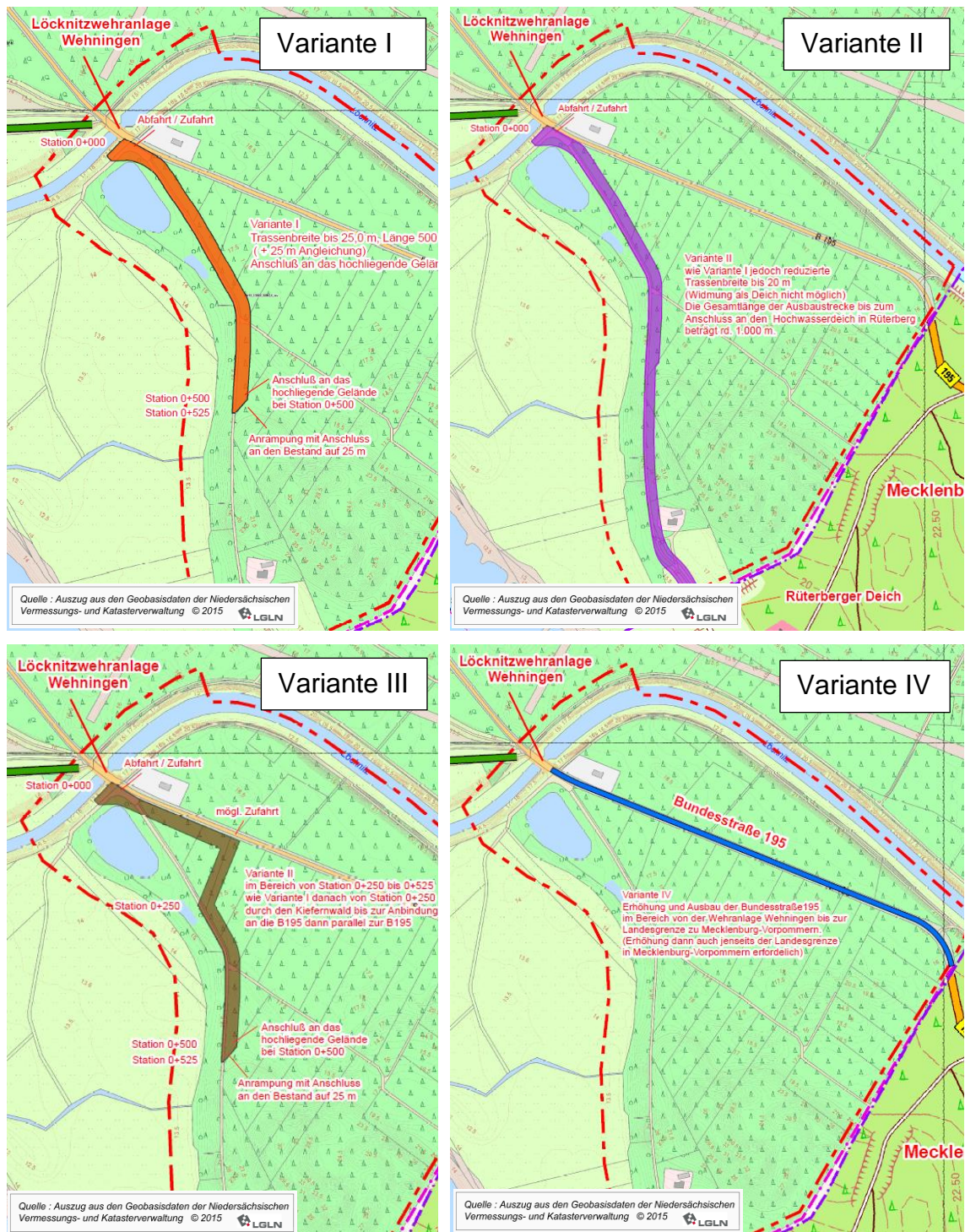
Abbildung 3: Übersicht der Varianten aus der Machbarkeitsstudie für einen Hochwasserschutz im Bereich Wehningen bis zur Landesgrenze Mecklenburg-Vorpommern (NLWKN LG, 2017)
