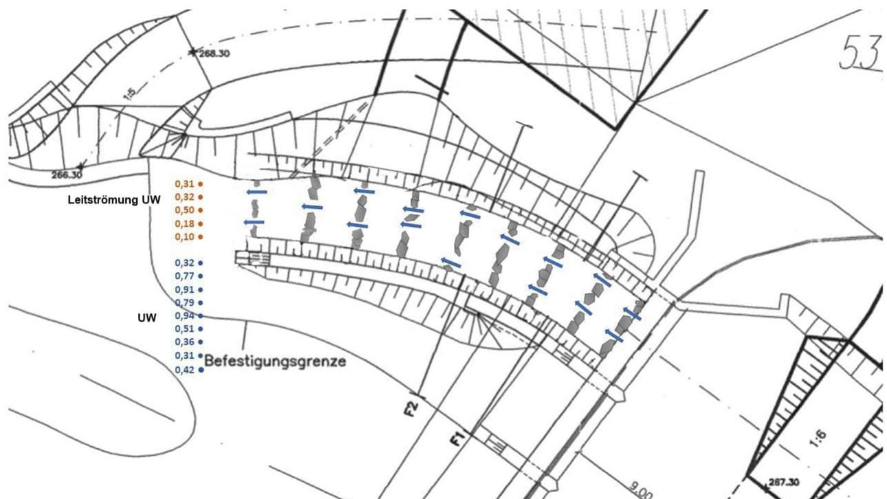
**Abbildung 7: Leitströmungsmessung unterhalb der FAA**
