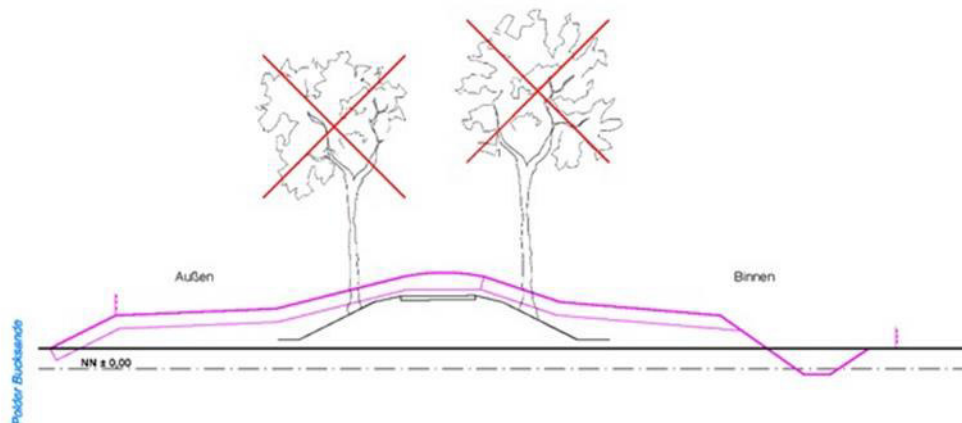
Abb. 1.1 Variante 1 Querprofil der Straßenerhöhung und Anpassung der Seitenräume nach innen und außen
