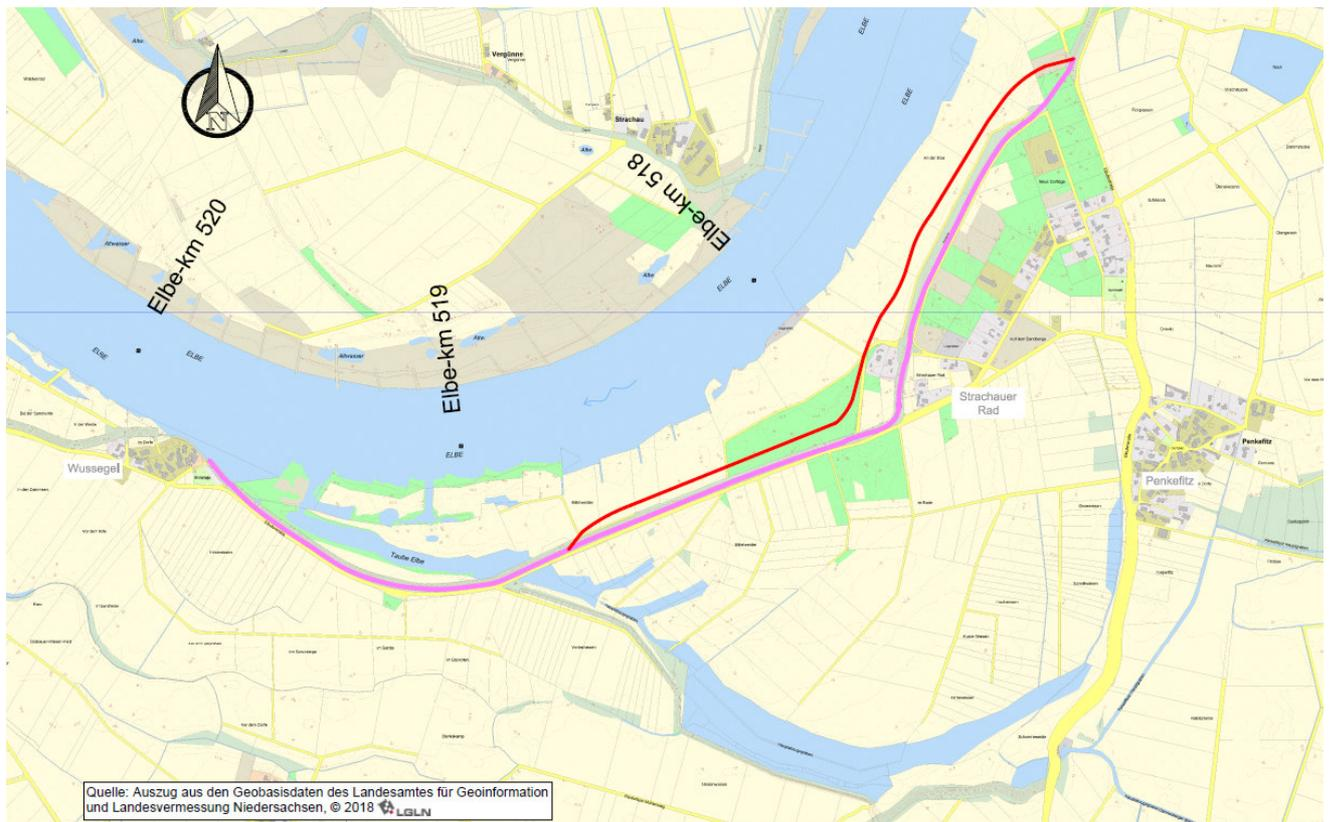
Abbildung 6: Schematische Darstellung der Variante 1 – Vordeichung (Rot-Trasse) und der vorhandenen Deichtrasse (Rosa) (unmaßstäbliche Darstellung), Bildquelle: NLWKN
