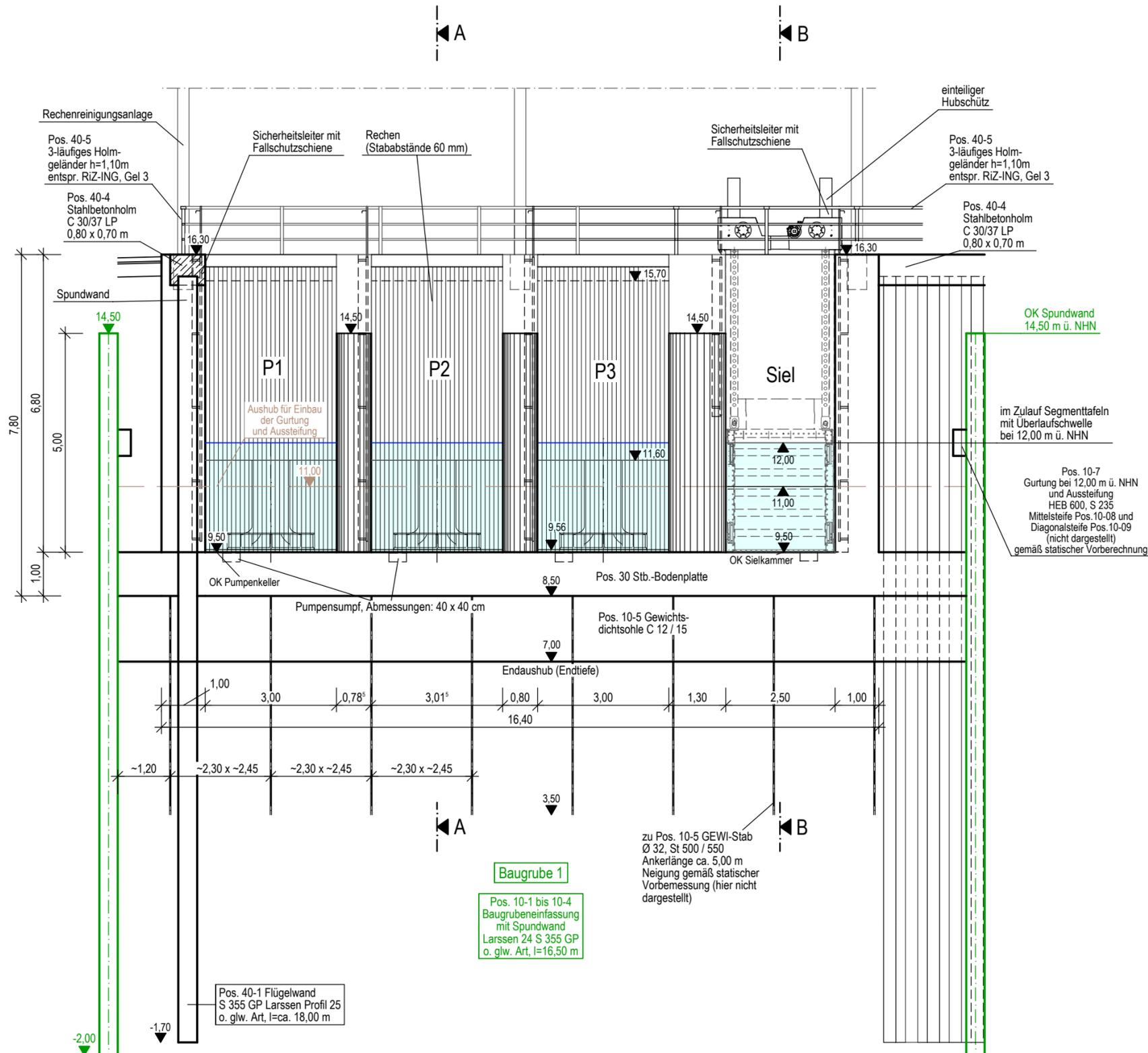
**Hinweis:** max. Wasserstand 12,50 m ü. NHN bei Wasserständen > 12,50 m ü. NHN ist die Baugrube zu fluten
