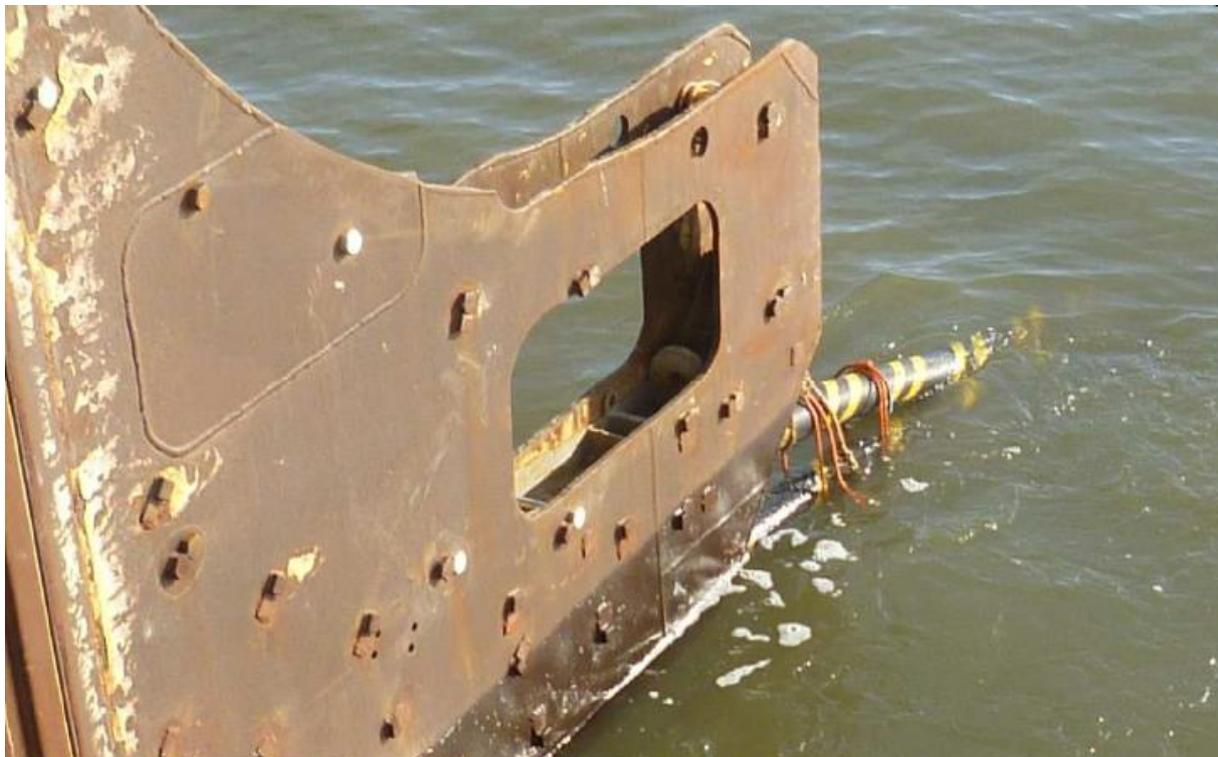
**Abbildung 23: Vertical Injector (unterer Teil des stehenden Spülschwerts)**
