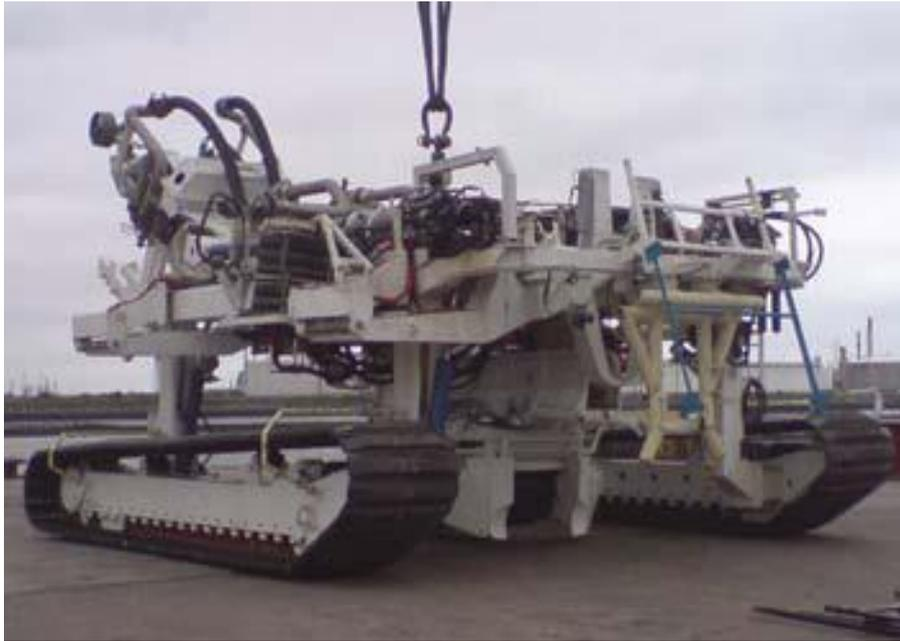
**Abbildung 15: Unterwasser-Eingrabegerät (TROV) mit Laufketten**
