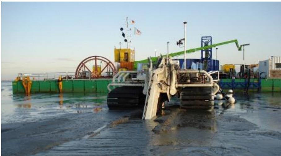
**Abbildung 11: Unterwasserfräse im Einsatz**
