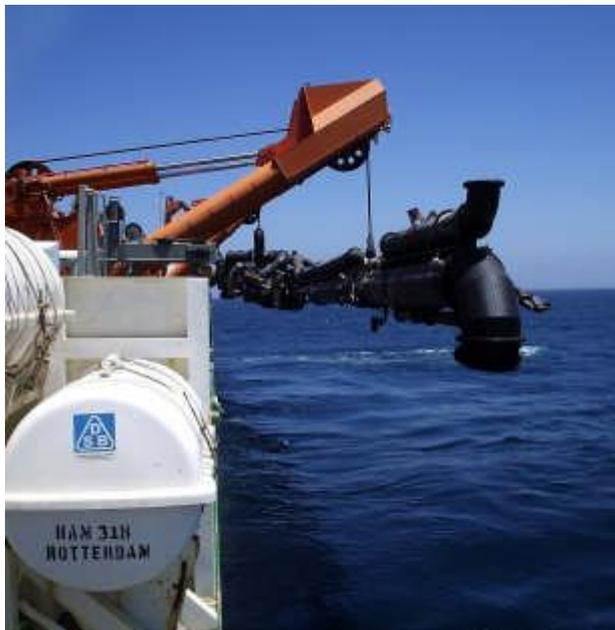
**Abbildung 26: Spüldüse (jet nozzles) des Mass Flow Excavators**
