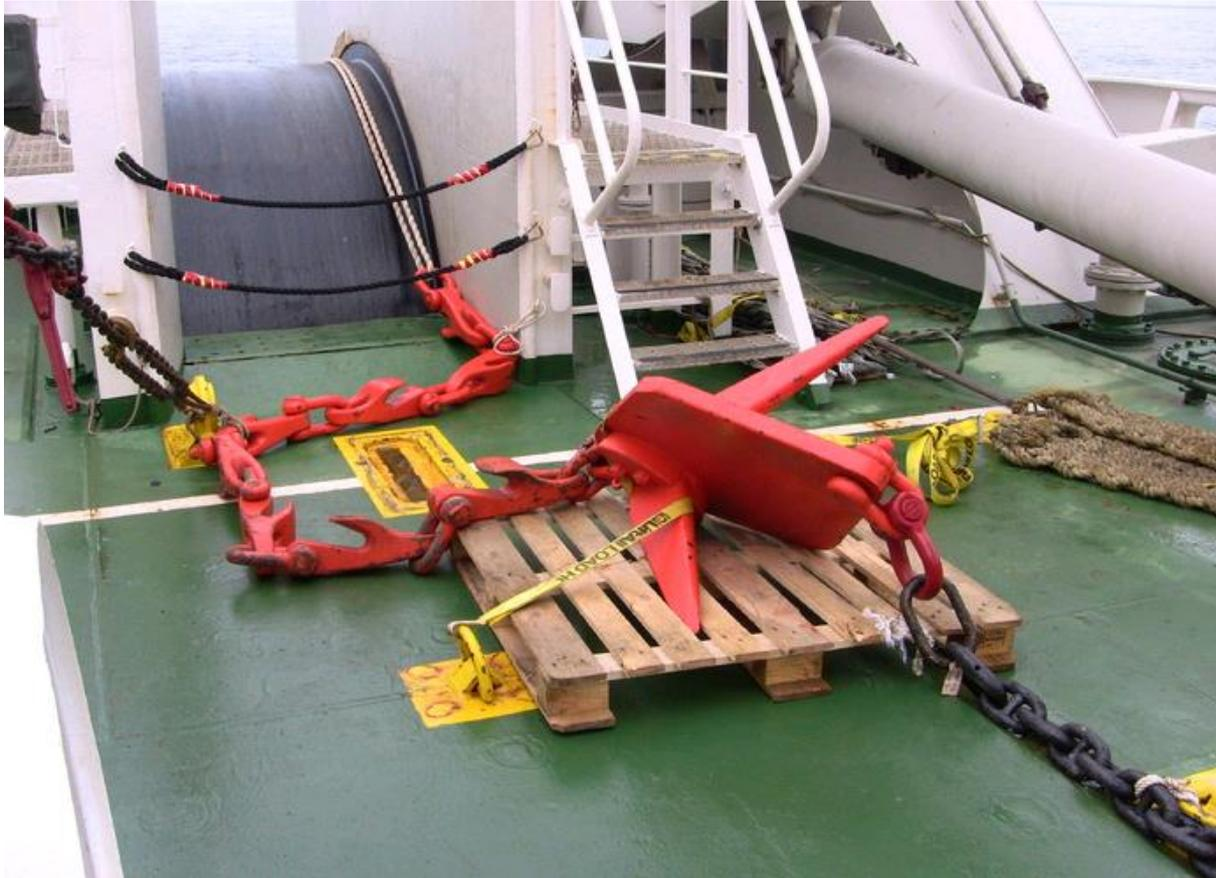
**Abbildung 1: Kette mit Suchanker und Drahtcatchern**
