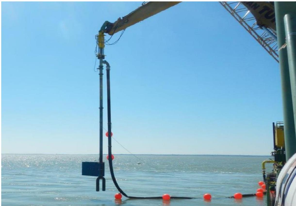
**Abbildung 28: Hydraulikbagger mit Spüllanze**
