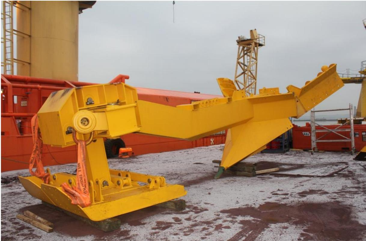
**Abbildung 3: SCAR Plough der Firma Ecosse Subsea**
