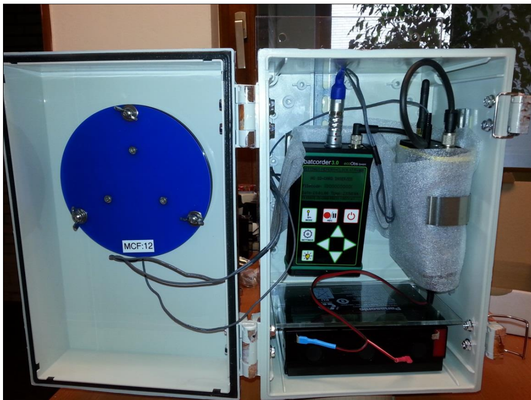
Abbildung 11: Daueraufzeichnungseinheit mit den Elementen Batcorder, Mikrofonscheibe, 6-V-12Ah-Bleigelakku, Steuereinheit u. Schutzgehäuse (Foto Zilz)
