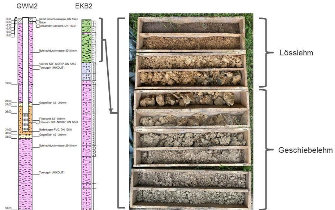
Abbildung 5: Erkundungsbohrung 2 – Messstellenausbau und Profilaufnahme
