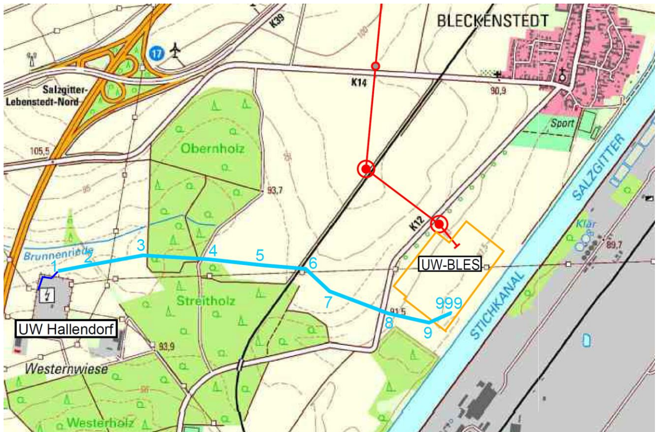
Abbildung 1: Trassenverlauf der provisorischen 220-kV-Leitung UW Hallendorf-UW Bleckenstedt/ Süd Provisorium Trafo (Freileitung und Mastnummern hellblau, Baueinsatzkabel dunkelblau, Umriss des UW Bleckenstedt/Süd orange, geplante 380-kV-Leitung Liedingen – Bleckenstedt/Süd rot)
