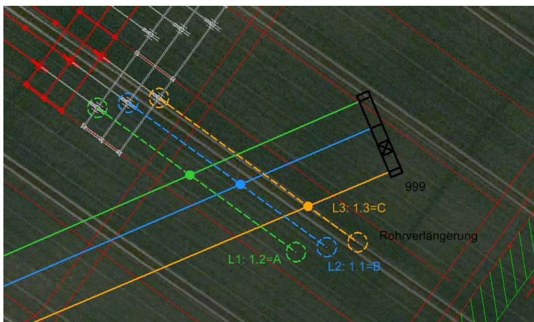
Abbildung 7: Schema zum Anschluss der provisorischen 220-kV-Leitung UW Hallendorf – UW Bleckenstedt/Süd an die Sammelschienen im UW BLES
