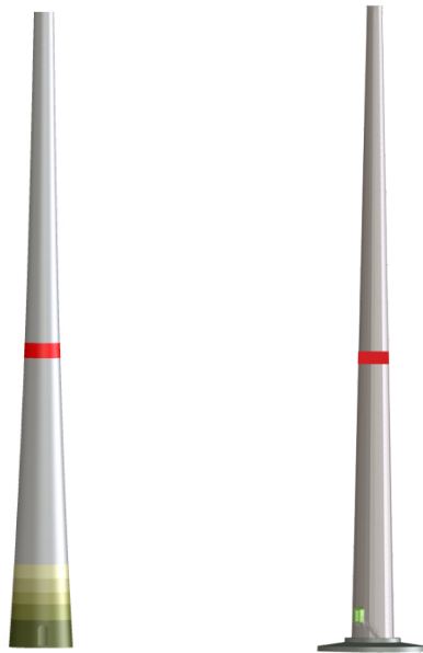
Abb. 5: Farbliche Kennzeichnung am Hybridturm (links) und am MST (rechts)
