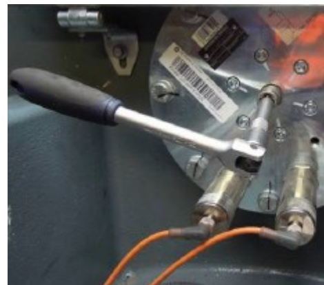
Abb. 16 : Einlegen der Rotorarretierung
