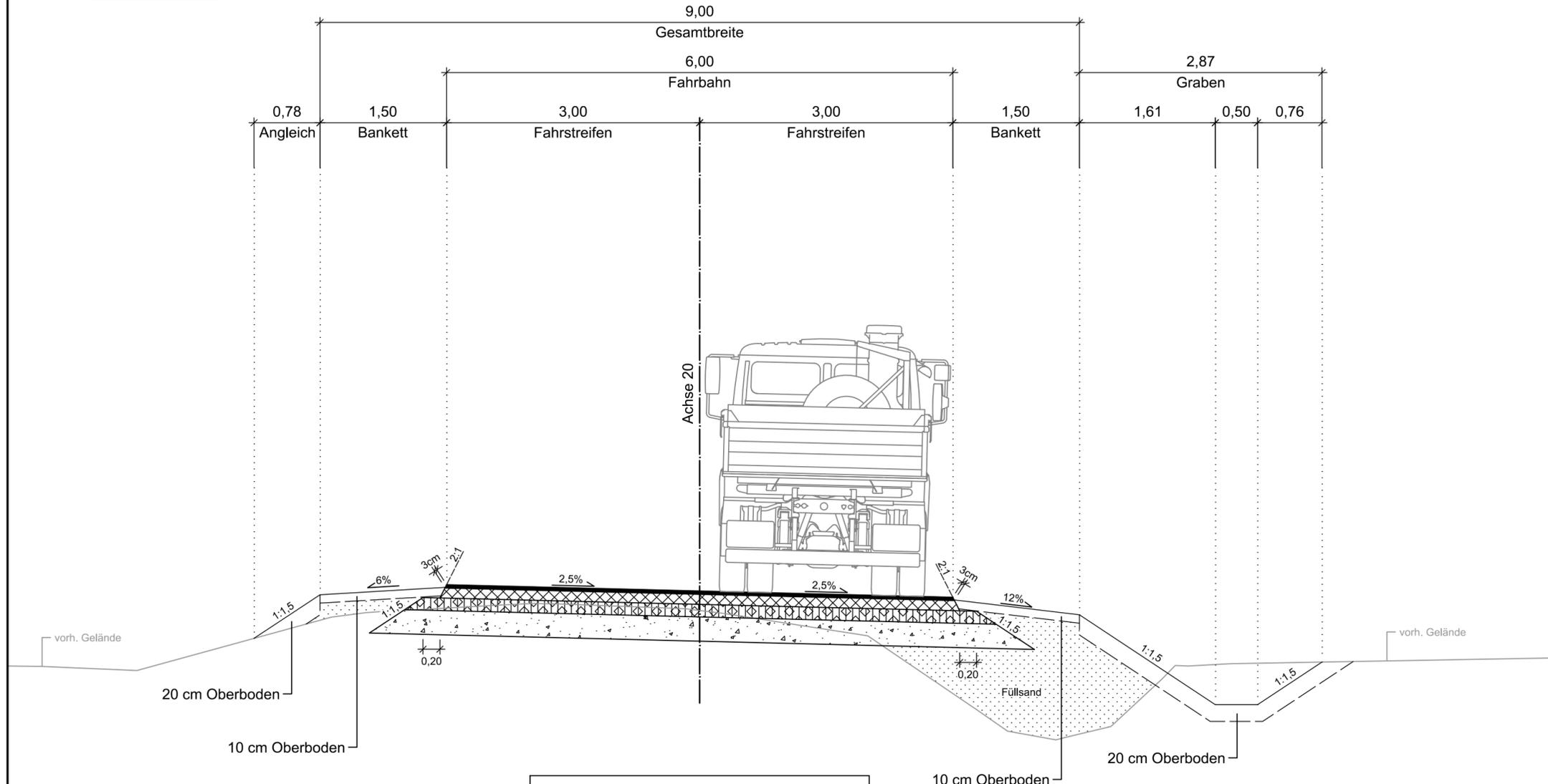
Oberbau Fahrbahn (Asphalt)
