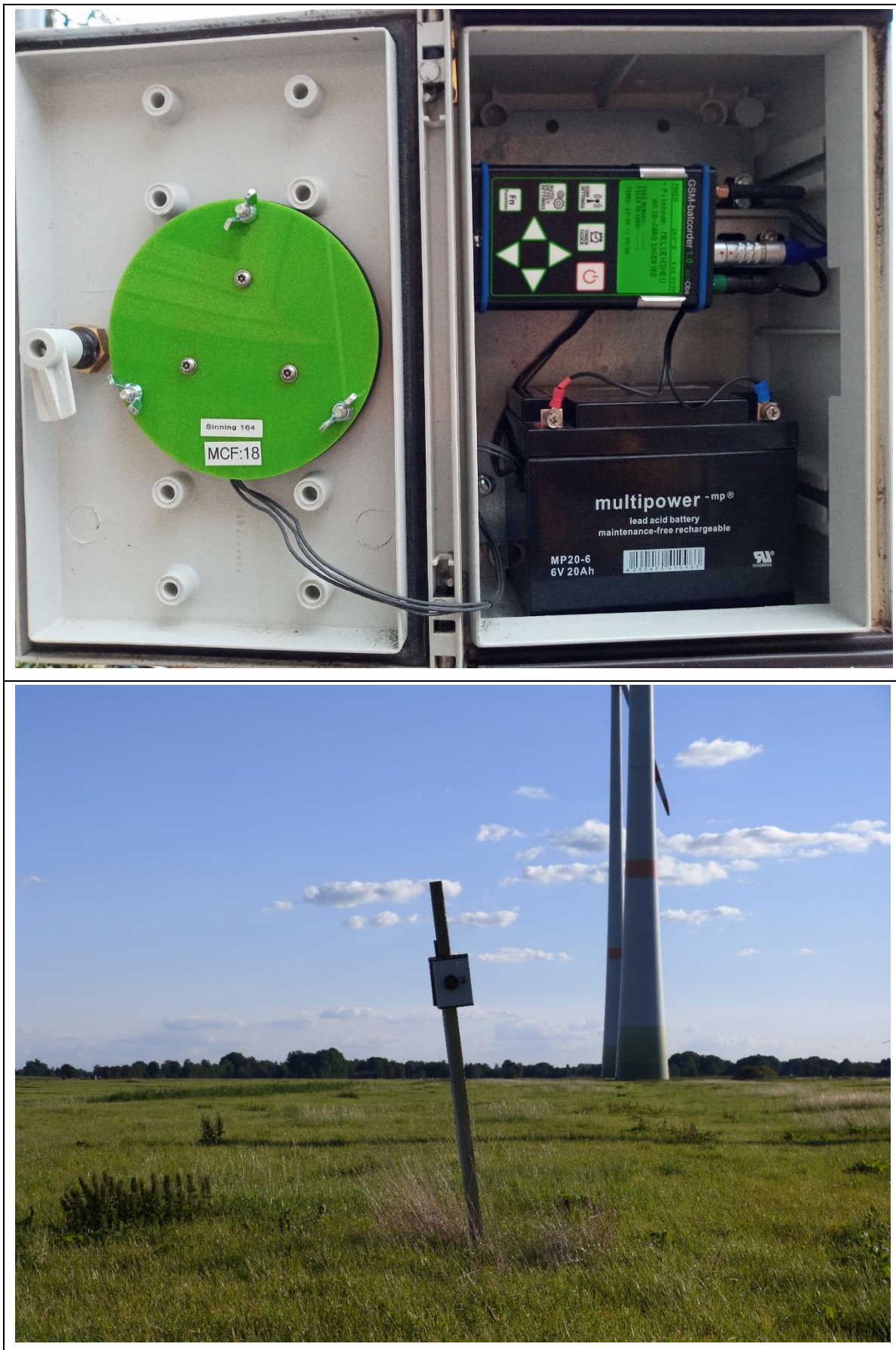
Abb. 4: Aufbau der batcorder-Technik im UG „Repowering Windpark Drochtersen“ 2020 (oben: Detailansicht Technik, unten: Geländeansicht batcorder)
