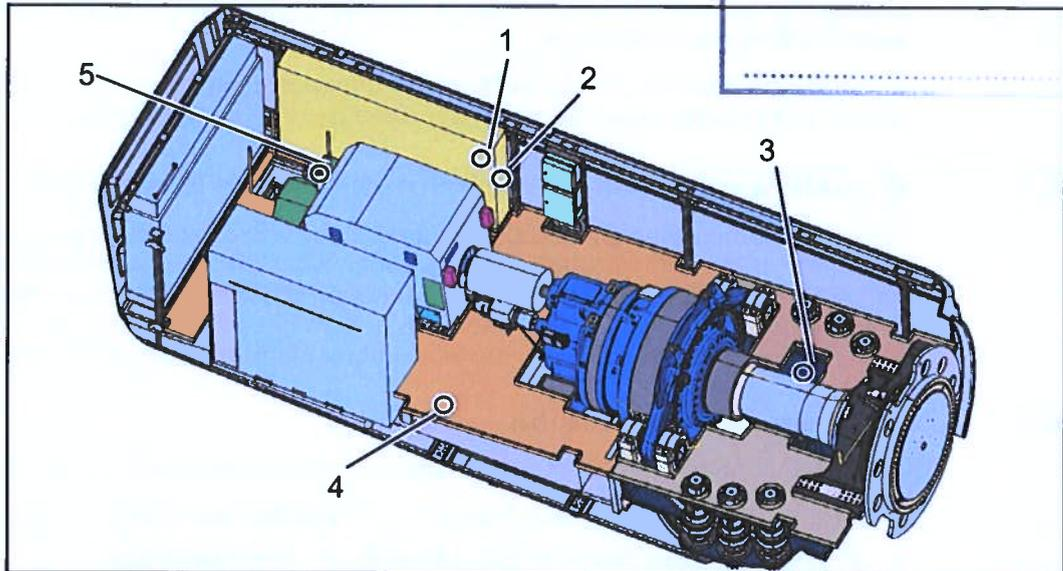
Abb. 15: Not-Halt-Schalter und Ausschalter Mittelspannung im Maschinenhaus
