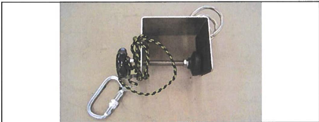
Abb. 25: U-förmiger Kantenschutz
