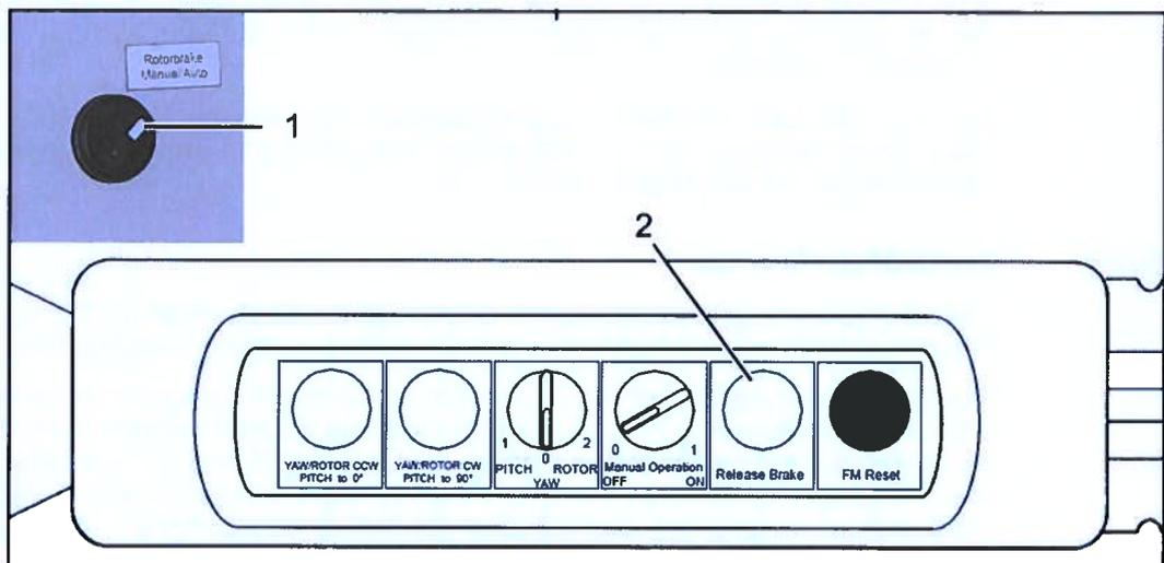
Abb. 22: Bedienelemente für manuellen Betrieb der Rotorbremse
