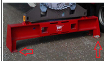
Abbildung 34: Beispiel einer Komponentenhalterung. Die Pfeile zeigen die Aufstandsfläche an.
