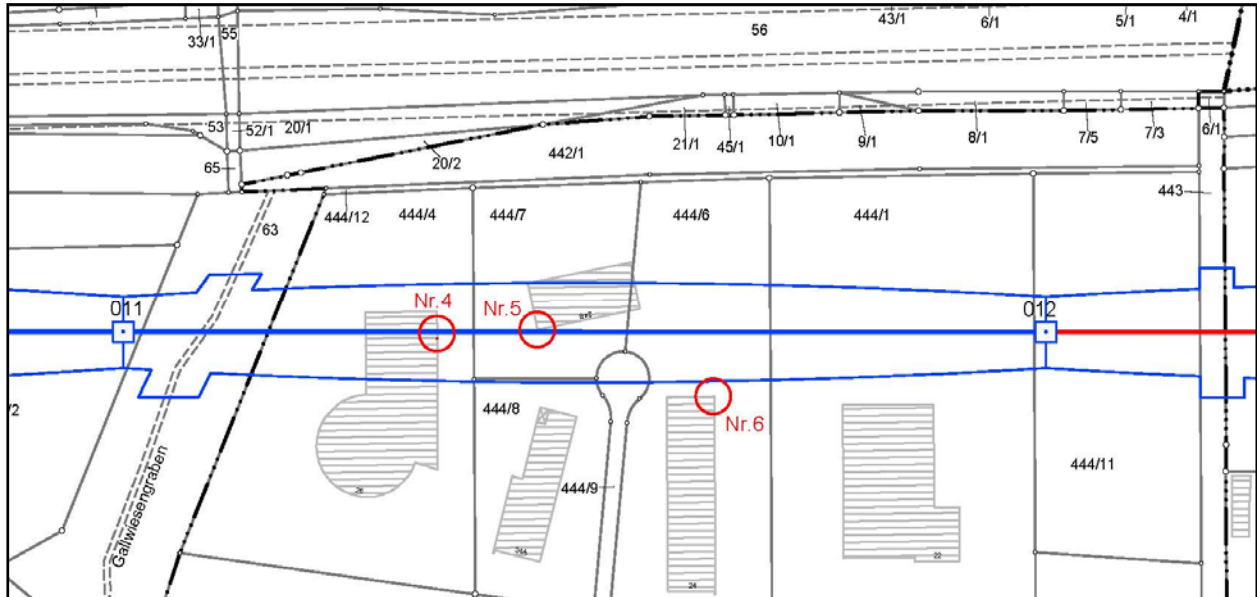
Abbildung 4: Immissionsorte 110-kV-Leitung LH-11-1008 im Mastfeld 011-012
