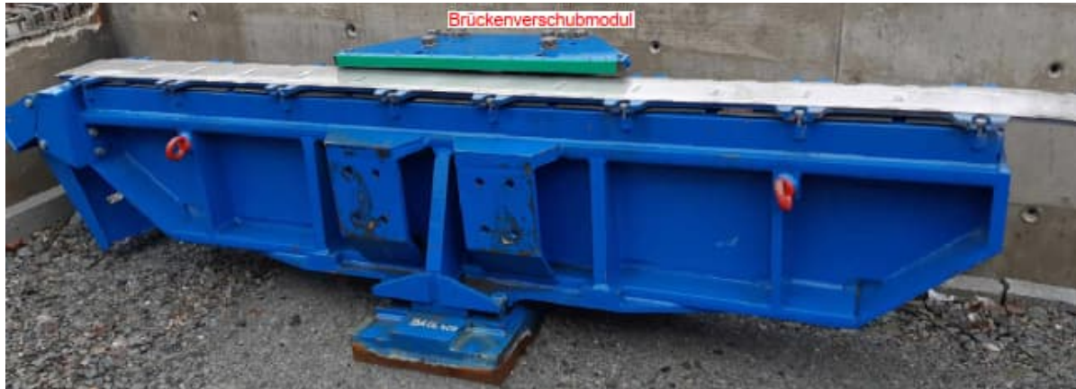
Abb. Verschubwippe, Ausschnitt aus Verschubplanung Phase 2 – Plan-Nr. 033527-001-14
