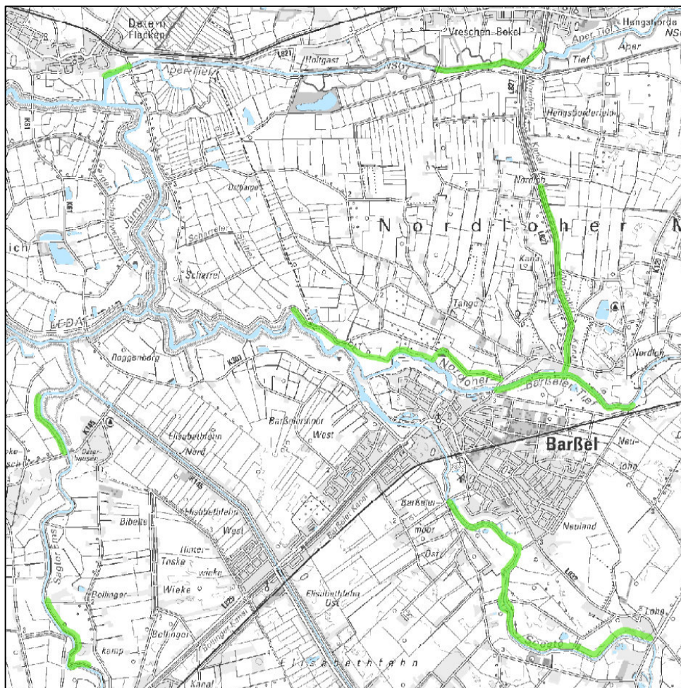
Abbildung 21: Deichstrecken im Leda-Jümme-Gebiet bei denen eine Bestickerherstellung stattfinden muss, Auszug aus Karte des Leda-Jümme-Verbandes „Kleibedarf im Leda-Jümme-Gebiet – zukünftige Deichbaustrecken“, März 2016 [56], verändert; grüne Linie = betroffene Deichstrecken
