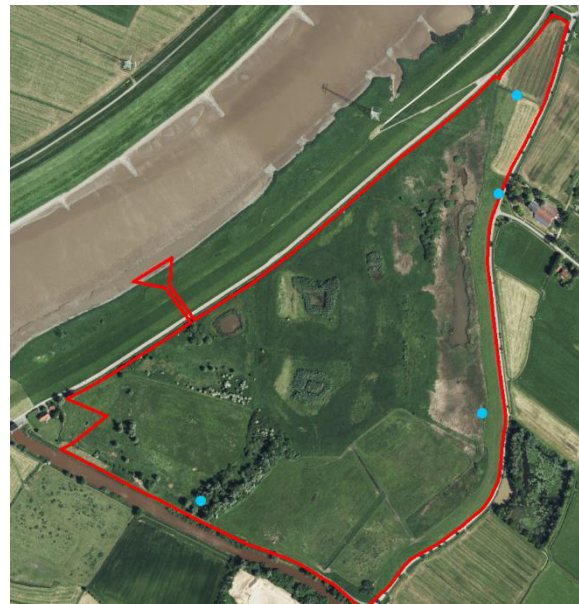
Abbildung 6: Standorte der eingebrachten Grundwassermessstellen (blaue Punkte)
