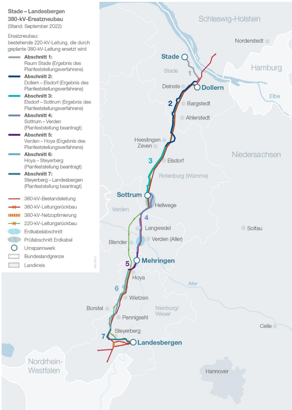
Abbildung 2: Planfeststellungsabschnitte (Quelle: TenneT TSO)
