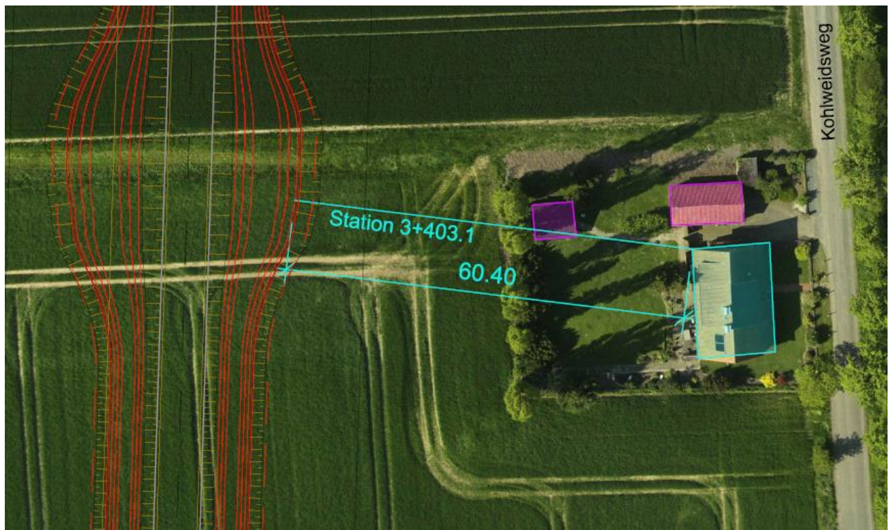
Bild 28: Annäherung der Kabeltrasse an ein Wohngebäude nahe Trassen-km 3+403,1
