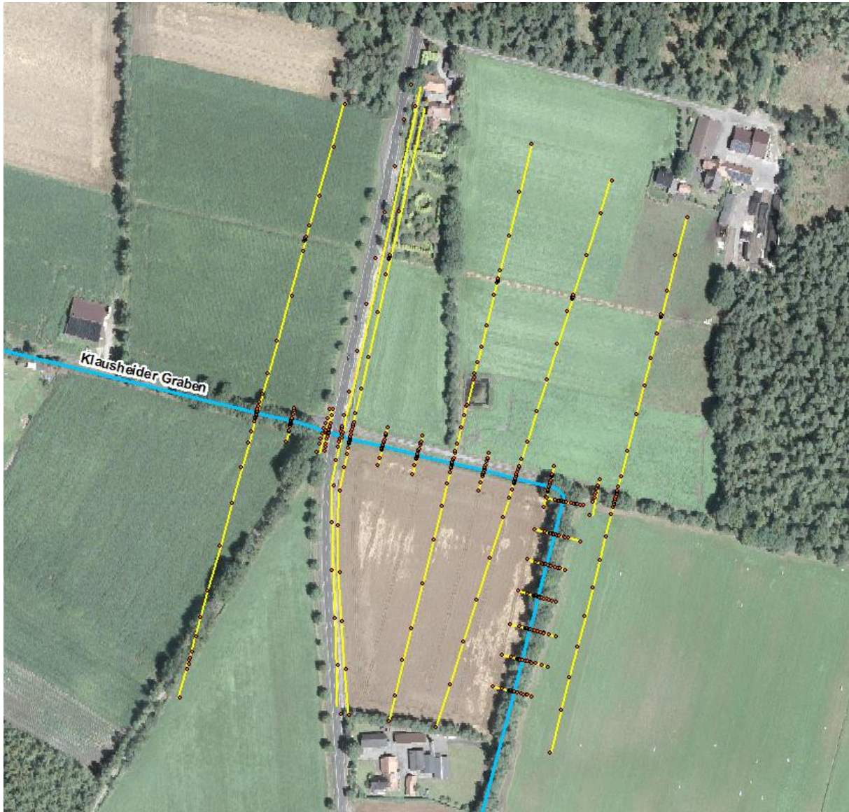
Abbildung 2-1: Darstellung der vermessenen Profilpunkte und Profile am Klausheider Graben vor Orthofoto (Auszug aus den Geobasisdaten der Niedersächsischen Vermessungs- und Katasterverwaltung © 2016)
